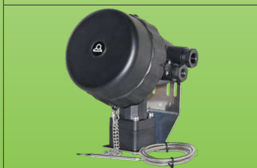
1 : Chainette de couvercle, 2 : Scellés rouges, 3 : Jeu de borniers, 4 : Sortie du capillaire par presse-étoupe M20, 5 : Sortie du capillaire par le pied de montage sur tube.
